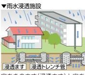
穴あきのます(浸透ます)と穴あき の排水管(浸透トレンチ管)を組み 合わせて浸透させます。
