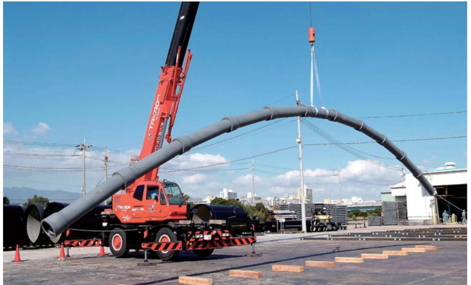
耐震管吊上げ実験の様子
